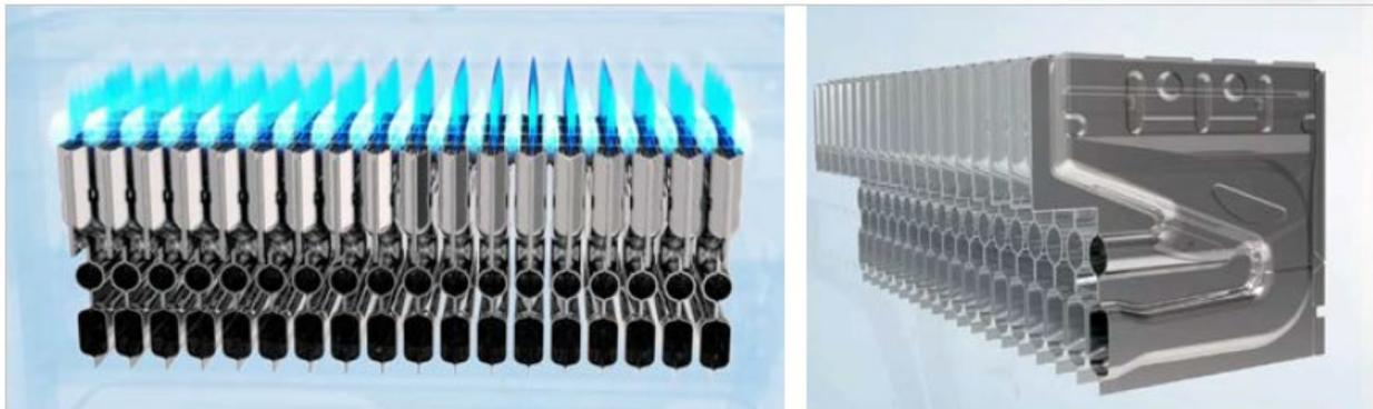
En la gama de calentadores de tiro natural Hydro, con tecnología de quemadores de llama azul el quemador es refrigerado con agua fría lo que provoca una baja temperatura de llama y en consecuencia unas reducidas emisiones de NOx.
